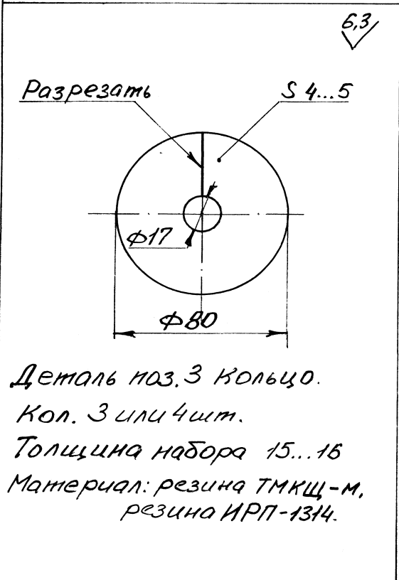
Рисунок А.7 - Гермоввод безфланцевого датчика. Деталировка.
